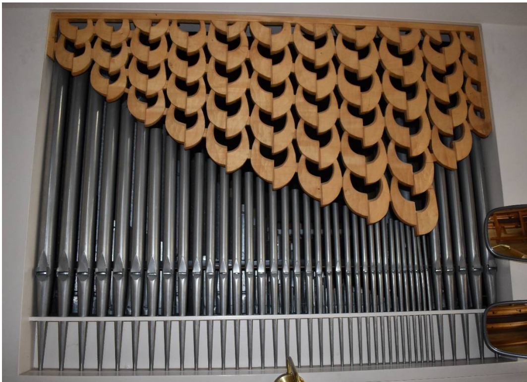
Abbildung 1 Das Schleierbrett über den Pfeifen des Oberwerks.
